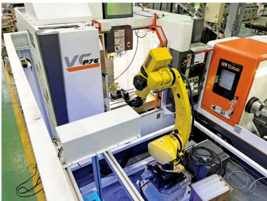
台中精機展出結合 Vcenter-P76 立式加工中心機與 Vturn-NP20 CM 臥式數控車床所組成的智能自動化生產線。
