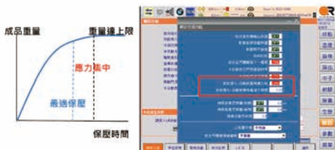
圖四、搭配模內感測元件進行保壓自調機能
