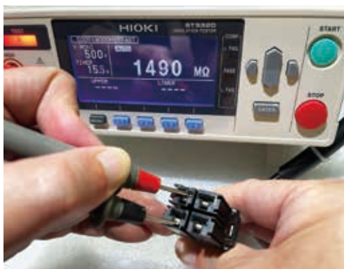
圖二 伺服馬達絕緣量測
