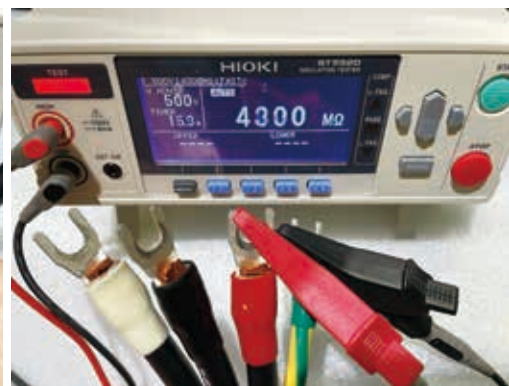
圖三 主軸馬達絕緣量測
