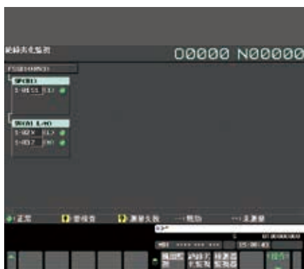
圖一 絕緣劣化監視畫面
