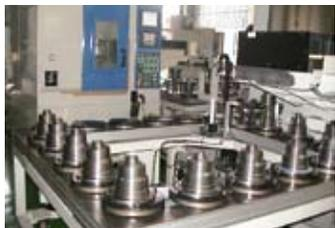
OP2(箱體)自動加工單元的佔地面積&排列和OP1(上蓋)類似, OP2a與OP2b的加工時間分別為6分45秒(比一般夾頭增加1分鐘)及6分50秒, 所以OP2總加工時間包括夾頭夾放工件為7分04秒; OP2(7分04秒)和OP1(4分5秒)的加工時間相比較, 可看出OP2多出很多。因此若考慮到加工效率, OP2可配置較多的Vturn-iV250。(OP1與OP2可以1比2來搭配); 另一方面因為Sandvik刀具的最大切削深度僅3mm, 所以也許可藉由較好的刀具來改善OP2總加工時間以拉近OP1的加工時間。
