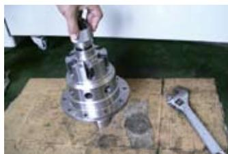
作者上下料。因為Vturn-26機種有優良的結構剛性, 所以剛好適合類似工件需要斷續加工; 此OP5工程總加工時間為3分50秒。
