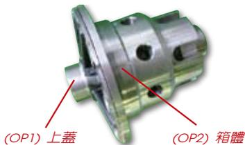
上蓋車削(簡稱OP1a+OP1b)由2台Vturn-iV250組成一個加工單元：每台VT-iV250倒立式車床皆配備其個別的工件輸送台 (Package C)，藉由移動式的翻轉台將兩台
