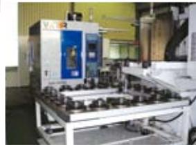
箱體車削(OP2a+OP2b)由另外兩台Vturn-iV250組成一個加工單元：OP2工程和OP1類似，同樣由兩台VT-iV250立車及移動式翻轉台所組成來加工箱體兩面，但是，因為箱體較大且重，加上鑄件品質精度不易控制導致夾頭自動夾料時可能產生夾持歪曲甚至有撞車的危險，所以必須使用不同於OP1的夾頭來克服。
