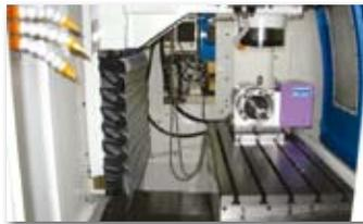
工將此箱體鎖入Vcenter-85加工中心機, 繼續做銑, 鑽加工(OP3)。此Vcenter-85配備北川旋轉工作台(型號MR-200)及工作台沖屑。因為OP3的加工時間為8分40秒, 所以客戶安排兩台Vcenter-85, 讓OP1, OP2, OP3加工時間能夠相近及聯結, 降低彼此等待時間產出最大產量。
