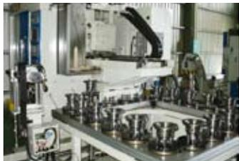
(3-2-2) OP2b採用特製長型軟爪如下圖所示可看出如何使用訂製的長型軟爪來加工OP2b。
