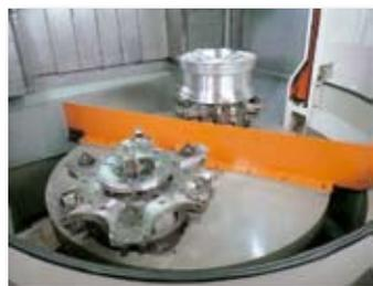
圖六 夾頭自動交換機構
