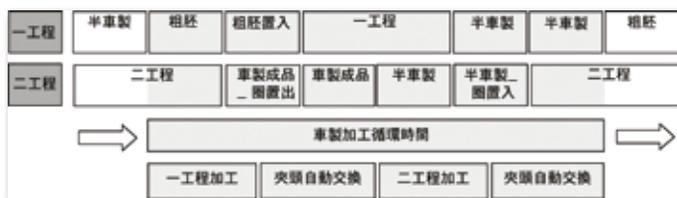
圖四 鋁輪圈車製加工循環製程
