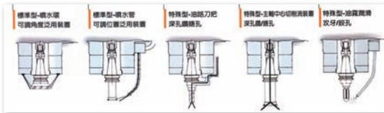
(圖四) :VcenterII-550/550L提供多樣化的主軸切削液沖屑系統
