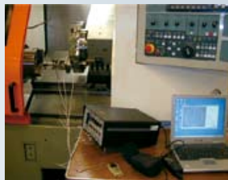
VICTOR 車床主軸迴轉精度測試架設範例。
