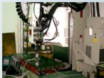
VCENTER 綜合加工機主軸迴轉精度測試架設範例。
