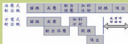
(圖一)全電式射出機複合動作縮短成型週期
