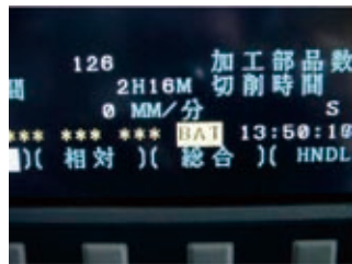
圖三 控制器電池異常狀態
