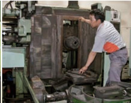
且精度較不佳的臥式中心機作大整修，目前的整修機台進度是機齡超過17年NIIGATA臥式中心機PN40及機齡約17年的第一套FMS系統中的四台NIIGATA臥式中心機H630，當然FMS系統的四台臥式中心機不是同時整修，而是一次整修一台，四台輪流作整修，這次的機台大整修模式，仍然是依照之前立式中心機整修方式，由廠內自行整修不外包，電氣部份由公司的服務部門協助維修，而機械部份則由製造事業處自行協調並管制整個維修進度，希望透過大整修可以讓這些機齡有點大的老舊機台恢復精度及性能，再度投入生產行列。
