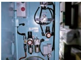
圖一 壓力檢出器及相關零件
