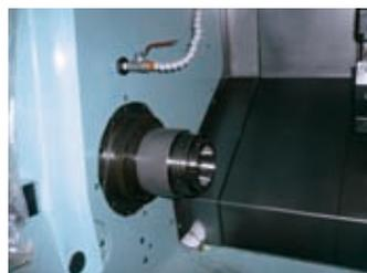
圖三 套筒夾頭搭配氣密檢出塊
