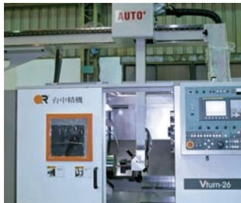
圖六 夾頭氣密檢出搭配自動化示意
