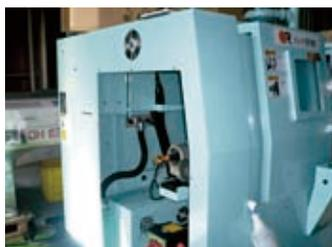
圖二 旋轉接頭配合中空油壓缸安裝
