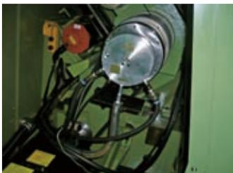
圖四 中實油壓缸配合氣密檢出功能
