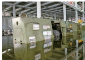
圖三：淹水超過1米，已淹到刀塔
