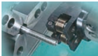
外徑滾牙器：(X進刀)使用時須注意滾牙器側邊厚度不會干涉到工件與夾具
