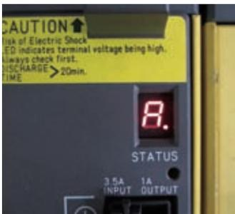
圖一 故障A狀態顯示
