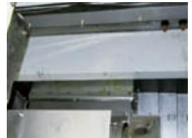
z軸除汙片使用加強橡膠及不鏽鋼板防屑
