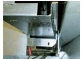
x軸伸縮護蓋及防屑板底部增加銅片刮刷防屑
