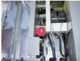
機台左、右內襯加焊6mm鋼板
