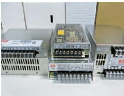
圖一 交換式電源供應器
