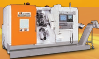
創新的三刀塔設計 Vturn-Q200多軸車床
