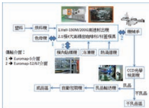
圖一、咖啡杯及杯蓋全自動生產線流程基本原理
