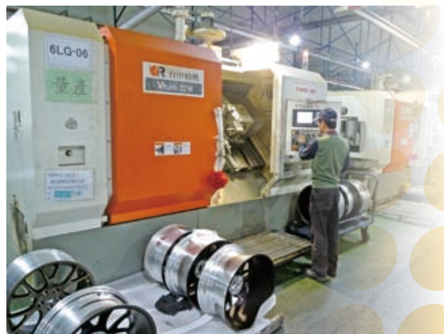
台中精機的數控車床被巧新廣為採用生產世界級的鍛造鋁輪圈
