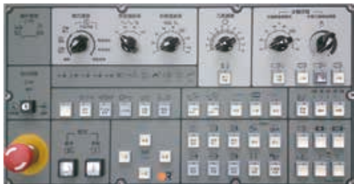
圖三：新式的尾座操作面板
