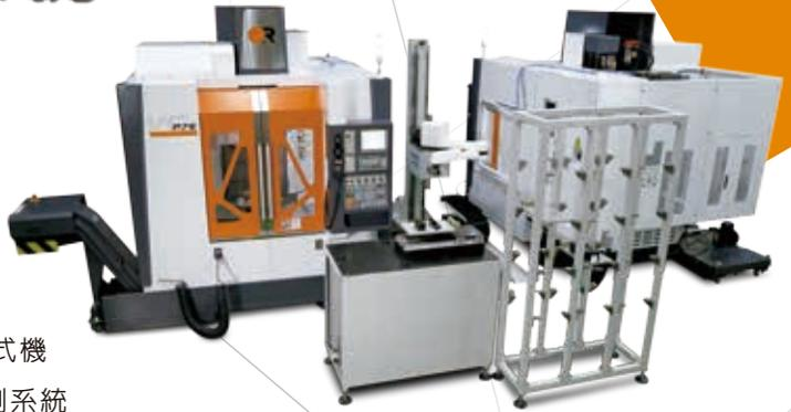
換模系統、縮短換料時間、提高機台稼動率。2、採用RFID方式判別、判斷使指定托盤停止於裝卸位置。3、系統可及時計算加工機之稼動率、產量等資料。4、混線生產,適合大量客製化生產的客戶使用。5、操作簡易,可選用各式模組化供料台。6、製程中監控,機台故障預防、保養策略。7、巨量資料蒐集(MES),產品生產履歷追蹤。
