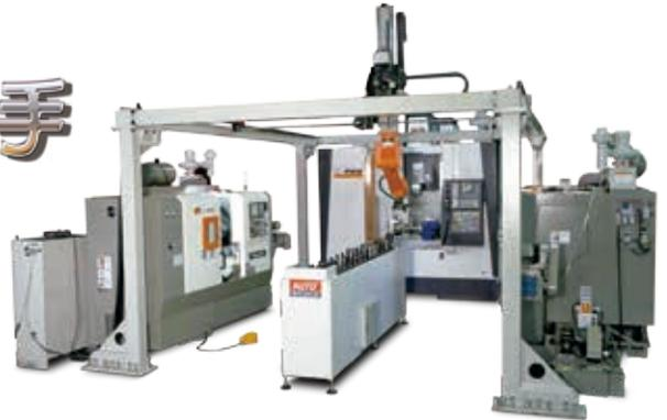
針對零件製程中需求車床二台及加工中心機一台的工件所規劃的自動化彈性加工單元，一台車床加工OP1，另一台加工OP2，中心機則是有角度銑削或鑽孔、攻牙等等。相較於門型機械手廠房要求較低(廠房高度受限的客戶)。這套自動化模組中選用兩台經濟型Vturn-20E機型，搭配Vcenter-P106機型並加上歐權第四軸+圓盤尾座+L塊，機械手則選用歐特加ATPAR-20J8(8軸)區域型關節機械手+27盤循環托盤自動供料機+V型工件翻轉暫置架。動作方面，工件的上、下料由區域式門型機械手與肘節式機械手組成一組，作為工件運送介面，在區域內任何位置的工件夾持，對於天井式機械手來說都不是問題，週邊裝置方面，可以搭配托盤料台、夾爪模組、翻面裝置、吹氣除屑箱、工件量測區等各式週邊裝置。這套模組可以建構成高效率、高彈性多組合性的生產設
