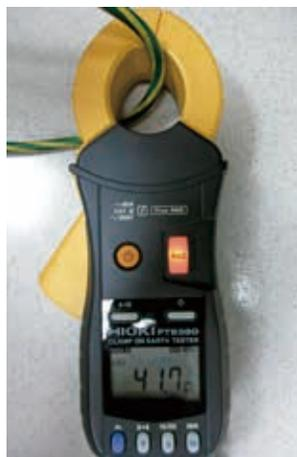
圖一 勾式接地電阻計
