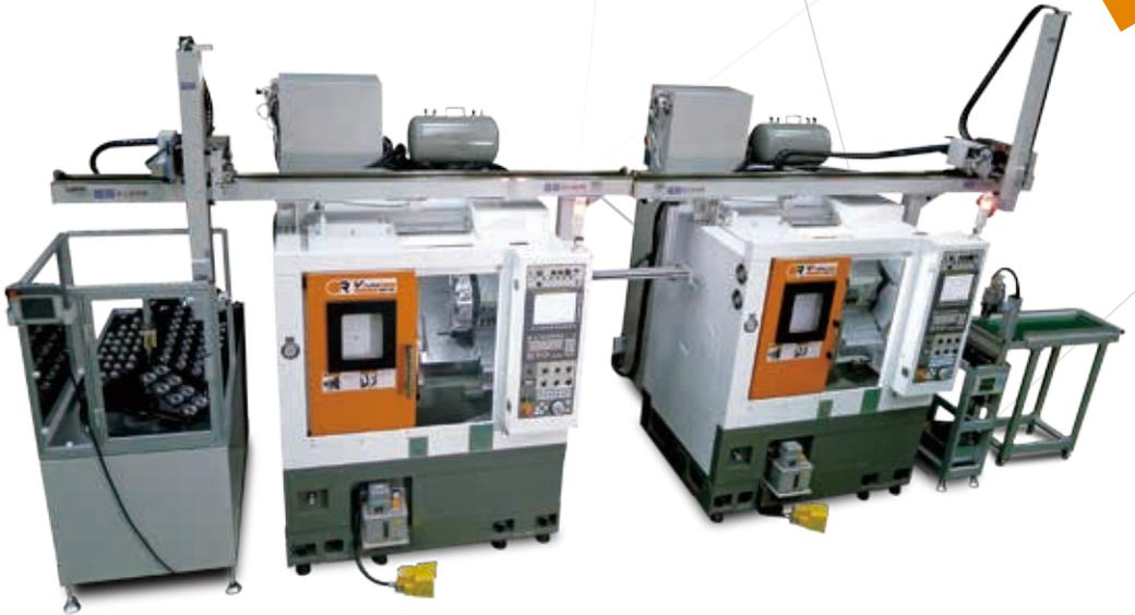
台中精機專門為自動化產線全新開發的高效率電腦車床Vturn-NP16(最新最小面寬機種)。機台配置彈性相當高，加上機台面寬小於1.5m可以將廠房的場地做極大化的運用，依照空間需求可以搭配後出式或側出式排屑機，產線規劃彈性相當高。如果客戶因人力考量有自動化需求，則可搭配機內或機外機械手，對於自動化規格相容性高。整體床台是透過有限元素法(FEM)結構優化設計，所以在動、靜剛性表現優異。滾柱線軌搭配高精度螺桿，軸向移動穩定度高。刀塔為高效率伺服驅動換刀速度快，三片式曲齒離合器結構設計，確保定位精度。可選配高壓切削液延長刀具壽命。在這套自動化模組選用兩台Vturn-NP16機台，搭配易立威二對二自動化加工系統(門型機械手\*2、機外量測系統：Renishaw VM25\*1、成品機械手\*1、自動供料台\*2)。特色說明：1、配合零件A、B面加工流程的平衡，提高生產效率(提升50%單工程效能)。2、結合自動量測補正
