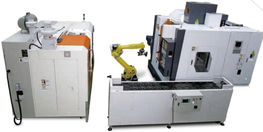
此套自動化模組針對工件製程中有車床及加工中心機互相運用需求，所規劃的彈性加工單元，選用台中精機高性能與高精度的A系列車床與新開發高性能P系列立式中心機，車床機型為Vturn-A26，中心機機型為Vcenter-P76，機械手選用FANUC關節型，搭配歐特佳27盤循環托盤供料器。Vturn-A26採用內藏式正、副主軸所以在切削表面紋路及真圓度與整體穩定性的表現相當優異。刀塔採用自製超高剛性及高精度的油壓伺服動力刀塔換刀速度相當快。冷卻水箱的設計可從前方移出方便清理鐵屑及水箱。新開發高性能中心機P系列- Vcenter-P76，具備以下優點：高快速進給、高轉速主軸、無配重塊設計、三軸向線軌設計、大寬度立柱設計在快速移動或切削加工時更穩定。特色說明：1、工件的上下料採用關節型機械手作為運送介面增加往後擴充方便性。2、搭配2D CCD 工件判別，增加料台使用彈性及降低成本，建
