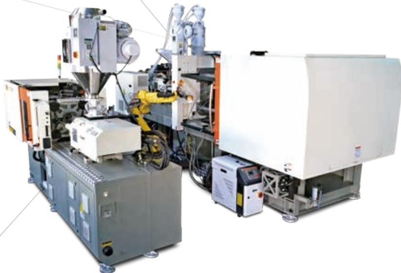
智慧化多射、射出系統 RC-220、VsP-60 V α II 二代全電式射出機可於生產中同時多動作，使成型週期時間縮短、提高生產效益，鎖模結構採寬模板與力集中式設計概念，以期因應模具及射出成型上更廣泛的應用，透過台中精機自主開發VPC2100-15吋觸控螢幕控制器，令控制與機台動作呈現完美搭配，達到媲美日系全電機台的各式機能。此次搭配日商模穴壓力及溫度偵測系統，於模具內嵌入數個 sensor，直接檢測模穴塑料壓力及溫度，這樣的作法將能逐模逐次地比對動態射出狀況與預設條件之差異，即時回報是否符合良品條件，一旦發生不符良品條件時，操作者能藉觀察模穴狀況進行有效率的成型參數調整，進而確保得到穩定無缺陷的高品質射出效果。展覽同時再搭配高性能FANUC機械手，如此一來就可以降低人力投注的成本，透過機械手的自動取
