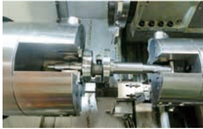
南X隆X案，在上下料時只需夾頭開啓與扶架上昇，即可進行上下料。
