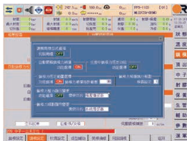
圖二、VSP油壓機鎖模力恆定機能設定畫面
