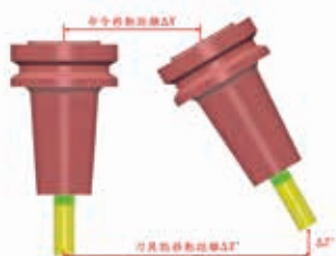
圖2. 5軸機刀具移動狀態
