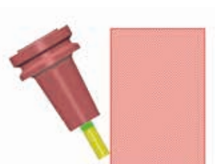
圖4. 刀具傾斜避免與工件產生干涉
