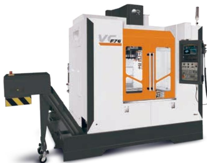
Vcenter-F76機械架構採用大A型立柱設計，以有限元素進行動靜態結構分析，具高剛性、高阻尼之特性。整機鑄件由「台中精機鑄造廠」依「米漢納製程技術」鑄造而成，提供全機台穩定的剛性基礎。高精度進給機構，軸向採用大尺寸高剛性滾柱線軌，具有高剛性、高負載的傳動剛性，三軸快速進給速率為32/32/32 m/min，軸向線軌加強防塵設計，減少因落屑及切屑水造成線軌損壞。
