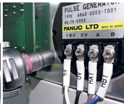
圖三 固定螺絲及接線方式
