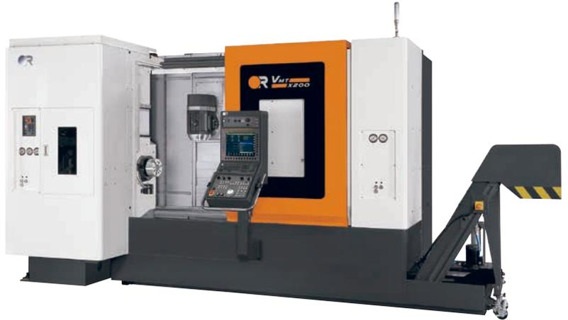
8. 車削主軸設計採用內藏式的正、右主軸 (選配)，直接以主軸作為轉子，省略傳動機構，所以在高速運轉時相對穩定，更不會產生極大的噪音與振動。
