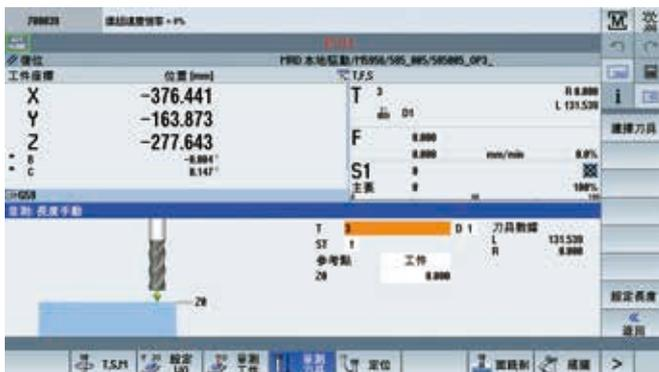
在量測刀具中，有分為正刀長量測及負刀長量測，對於一般三軸中心機而言，使用正負刀長進行加工都不會有影響，但對於五軸機而言負刀長會影響座標計算位置及機台擺動方式，所以在使用五軸機時一定要使用正刀長。
