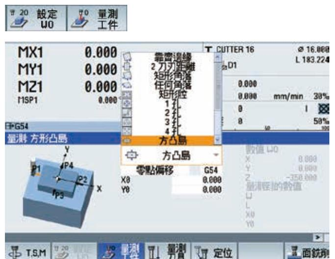
在 SINUMERIK 設置工件原點有兩種方式，在 T, S, M 旁的設定 W0 與量測工件，設定 W0 方式是直接設定工件原點，移動到哪設定原點，那個位置即為原點，而量測工件是依自行所需選擇量測方式，像是量測內外圓、方形腔室、凸島等，選擇完量測方式後，依序儲存 P1、P2、P3、P4 設置即可。
