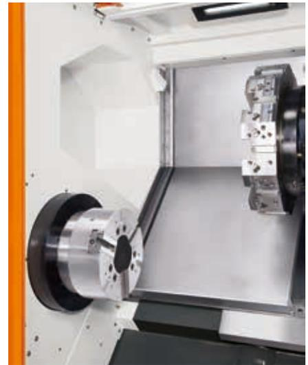
尾座心軸內孔使用 M.T.#5 型，尾座心軸作動行程 100mm，配合活動式頂心尾座可由 Z 軸鞍座帶動，尾座夾持定位採用雙油壓缸夾持設計，擁有高夾持力確保頂心頂出時尾座不後退，有效與夾頭兩端支撐工件加工手動中心架同時可選配供挑選使用，夾持直徑範圍為  $\varnothing 30\text{-}\varnothing 300\text{mm}$ ，有效搭配夾頭及中心架及尾座三點支撐長型的工件。
