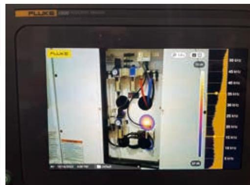
圖三 氣體洩漏偵測
