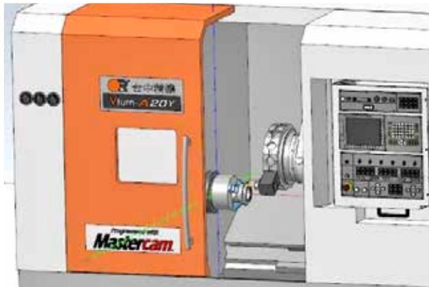
圖八 CAM 模擬加工路徑
